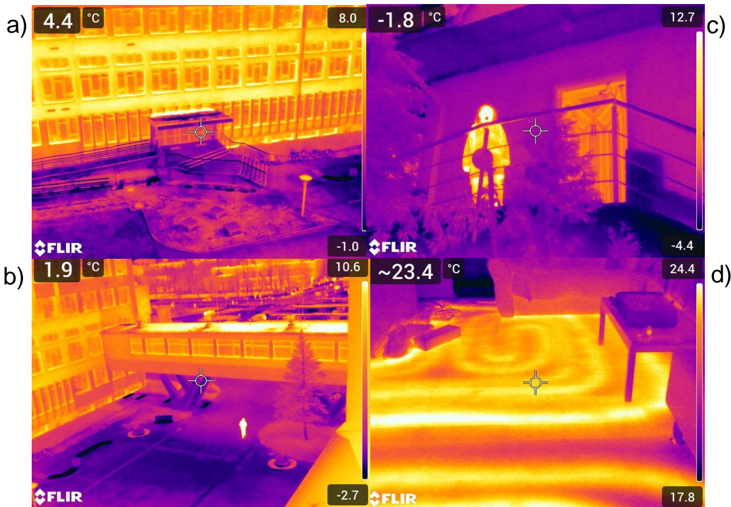
Termogramy z kamery termowizyjnej przy niskich temperaturach otoczenia (warunki zimowe): a) wejście do budynku C Politechniki Świętokrzyskiej, b) przejście łączące budynki PŚk, c) sylwetka człowieka i drzwi zewnętrzne budynku, d) rozkład temperatury powierzchni podczas pracy ogrzewania podłogowego w budynku
